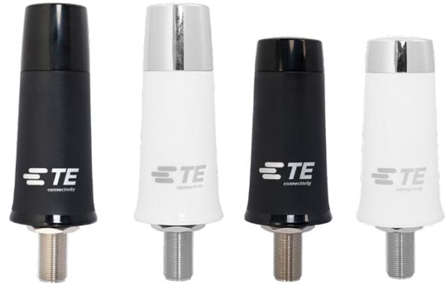
5G Phantom NGPアンテナシリーズは、グランドプレーンに依存しないフォーマットで617-7125または698-7125MHzの両方に対応します。600MHz以下の帯域が必要な地域でも、固定されたグランドプレーンを必要とせず、グローバルなセルラーカバーレッジを提供します。IP67準拠のコンパクトな設計で、4200MHzまで95%以上の高い平均効率と最大8.0dBiのアンテナゲインを提供します。
